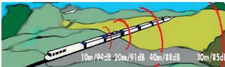
Figura 5 Propagação de uma fonte sonora do tipo linear ( www.apambiente.pt ).
