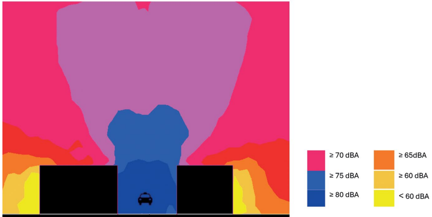
Figura 8 Propagação vertical do ruído emitido por uma estrada (ao centro) ladeada por dois edifícios.
