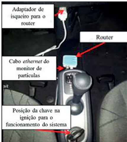
Figura 39 SMMART: Sistema de comunicação instalado no veículo.
