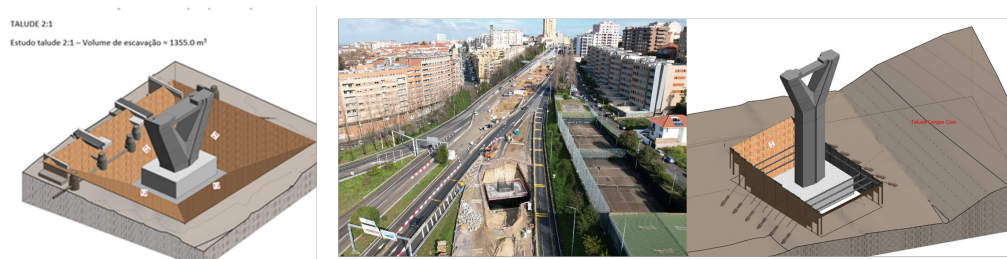
Figura 6 Viaduto: Estudo de contenções e implantação fundações dos pilares.
