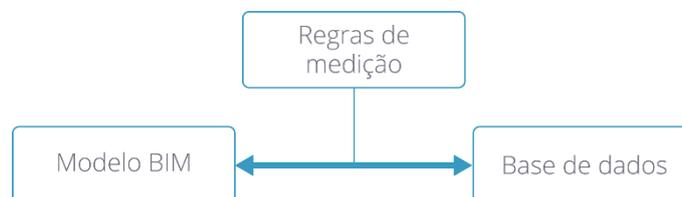
A figura 3 pretende resumir o fluxo de trabalho centrado no Open BIM Quantities. Após sincronizar o modelo BIM o Open BIM Quantities apresenta-o no ambiente de trabalho do programa, paralelamente apresenta uma árvore de componentes onde se podem identificar os componentes contidos no modelo. A estrutura de dados apresentados na árvore de componentes segue o esquema da norma IFC que pode ser visualizada de duas formas: por entidades ou por estrutura. No primeiro caso
