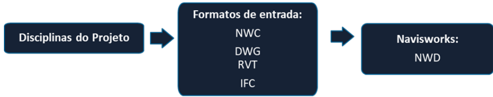
Figura 4 Fluxo de elaboração de um modelo federado no Autodesk Navisworks.
