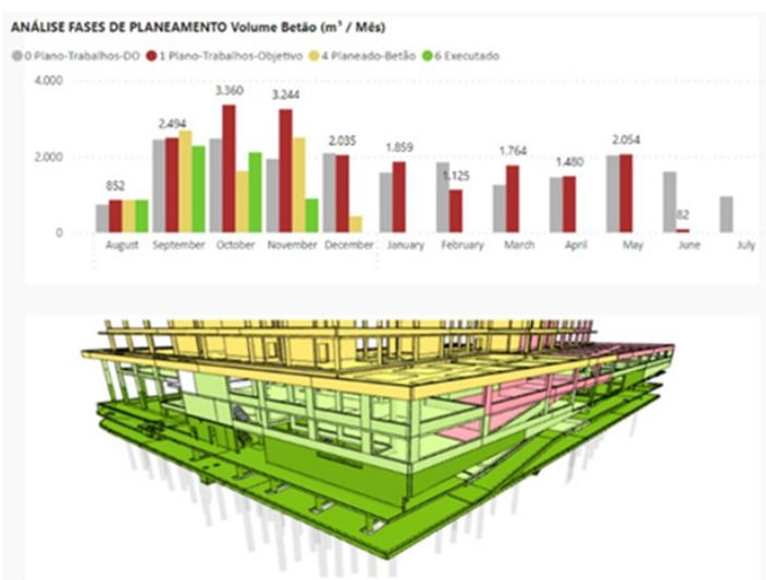
**Figura 4** Dashboard PowerBI com ligação ao faseamento de obra.
